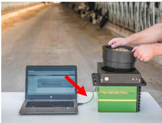
2. Para conectar o sensor HarvestLab™ 3000 a um computador, é necessário alterar as configurações do adaptador de rede.
