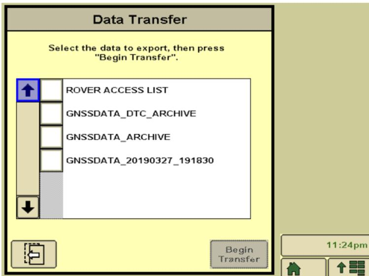
Captura de Dados de Prioridade Média — O receptor StarFire™ 6000 agora oferece ao usuário a opção de capturar dados de determinados DTCs. Quando os seguintes DTC são acionados, GR6 DTC 523348.16 e 523348.07, haverá uma opção na máscara de alarme para capturar os dados.
