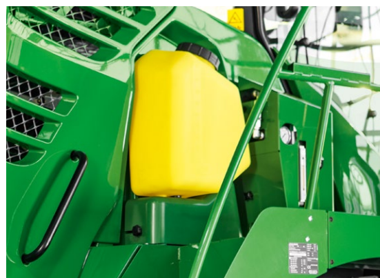
Depósito de concentrado de 30 L
